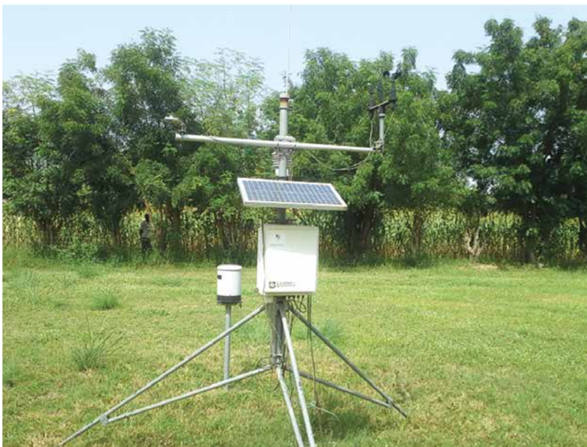
Modèle de station météorologique automatique Photo : Bouba Traoré, ICRISAT-Mali
